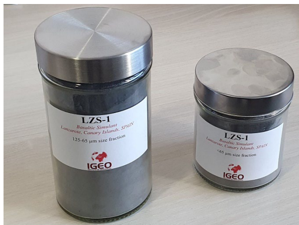
Fig. 19: Simulante regolítico basáltico lunar (dos fracciones) que se asemeja a los materiales de la zona de Fra Mauro (Apolo 14) (Alberquilla et al. 2022; Alberquilla y Martínez Frías, 2022)
